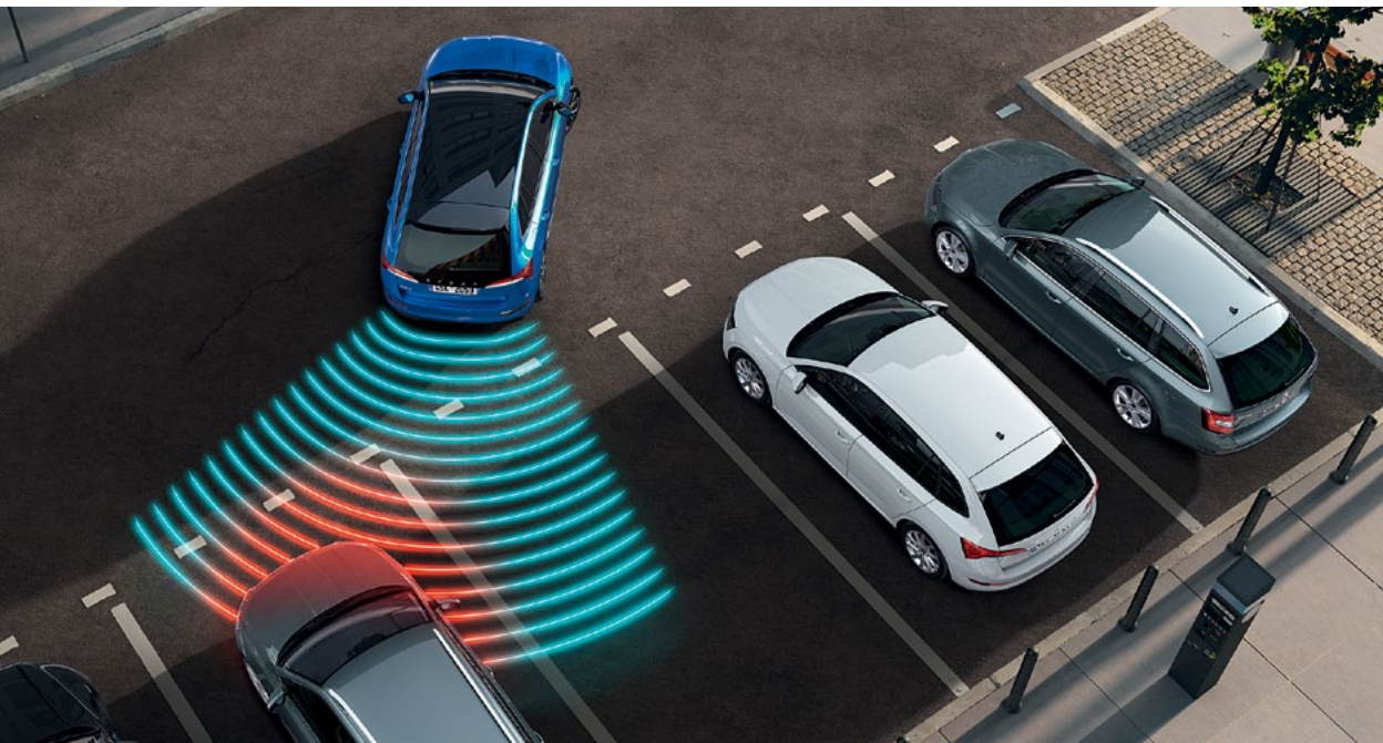
Parkimisandurid Scalaga manööverdamin eon lihtsam tänu esi- ja tagakaitserauda integreeritud parkimisanduritele, mis jälgivad auto kaugust mistahes takistustest.
